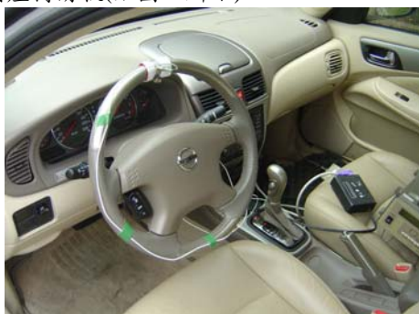
圖 2、方向盤加速規架設位置。
