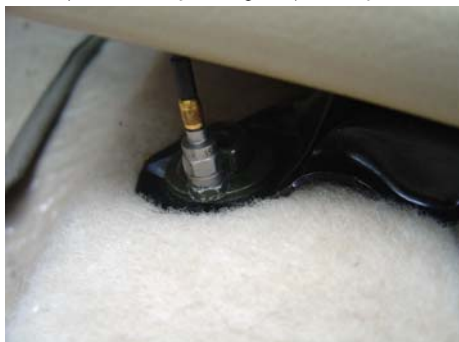
圖 3、座椅腳加速規架設位置。
