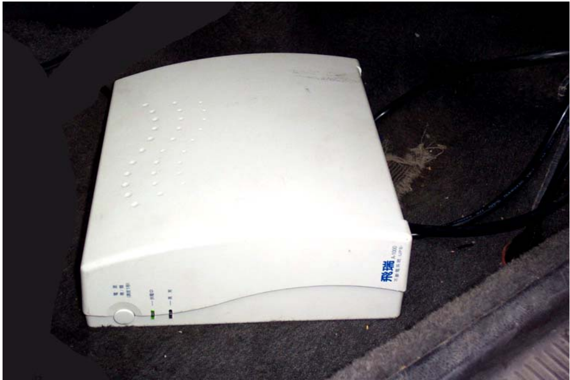
圖 3-6 不斷電系統(UPS)
