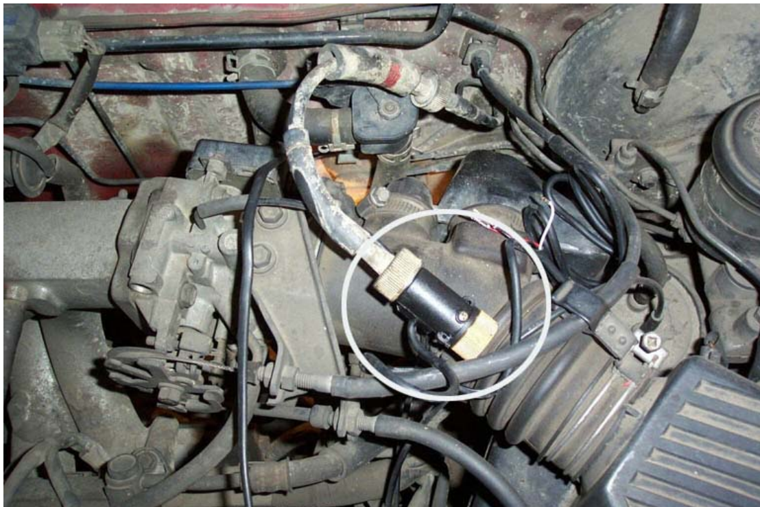
圖 3-3 里程計(安裝於車底變速箱)
