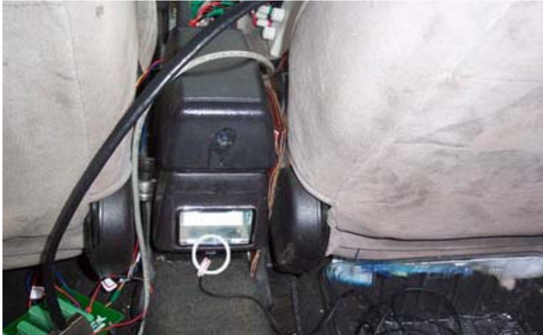
圖 3-4 加速規安裝位置(後座，接近車輛底盤)
