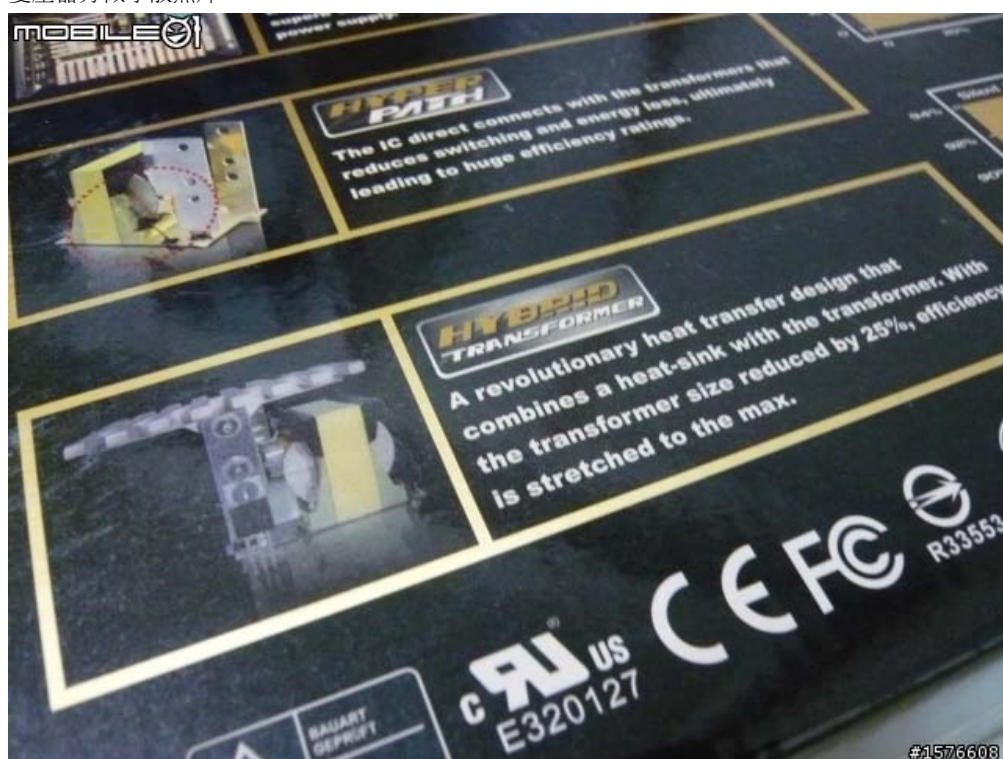
變壓器旁做了散熱片
