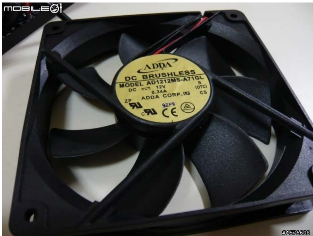
風扇使用ADDA金標風扇 用2PIN溫度控轉
