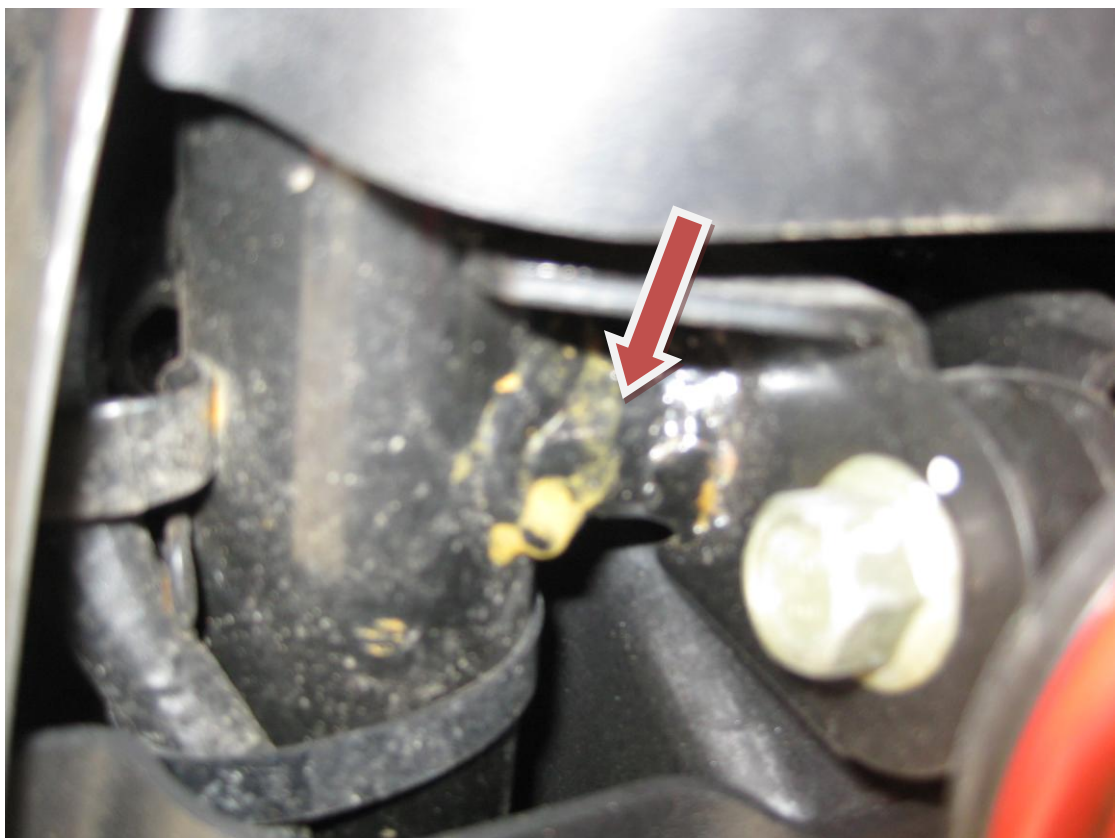
圖六、滴落銹水原因：車架焊接處銹蝕（後座下方）
