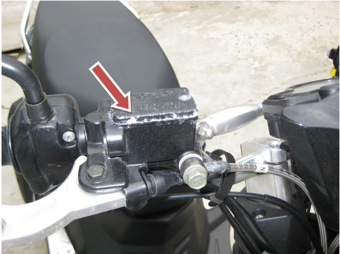
圖四、右邊煞車油杯出現白色銹蝕情形
