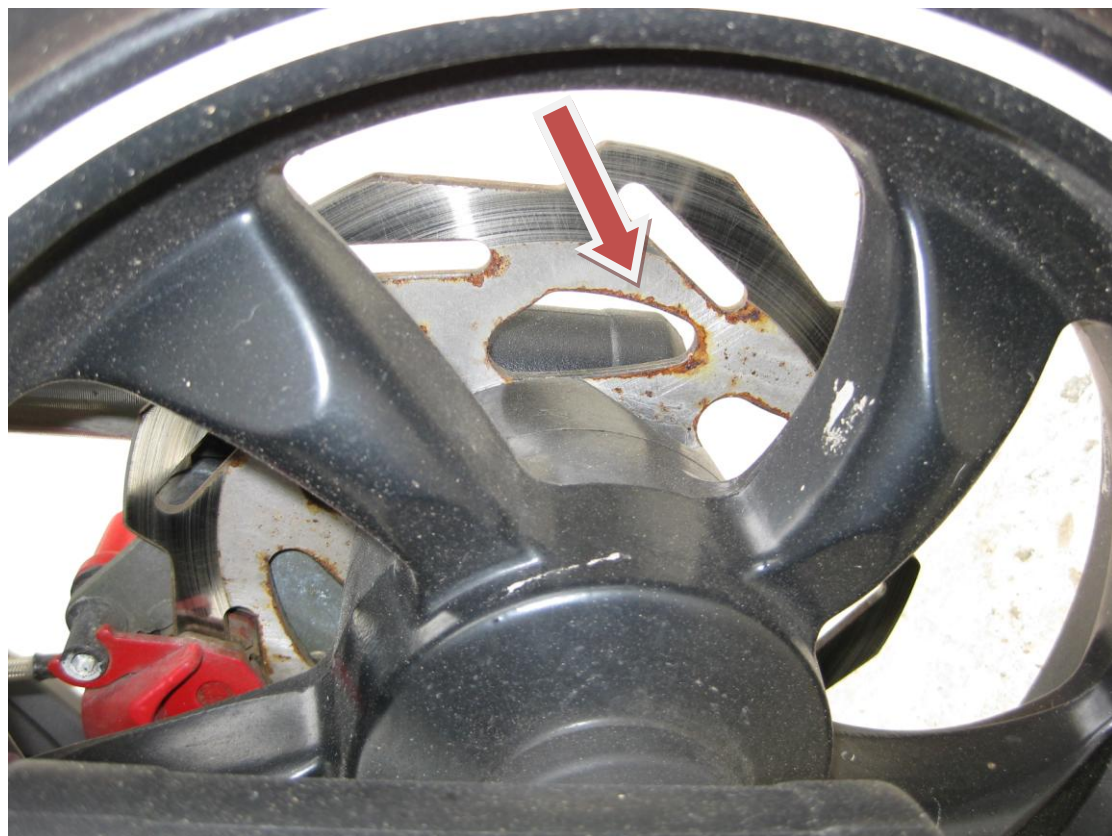
圖十一、碟煞盤生銹情形
