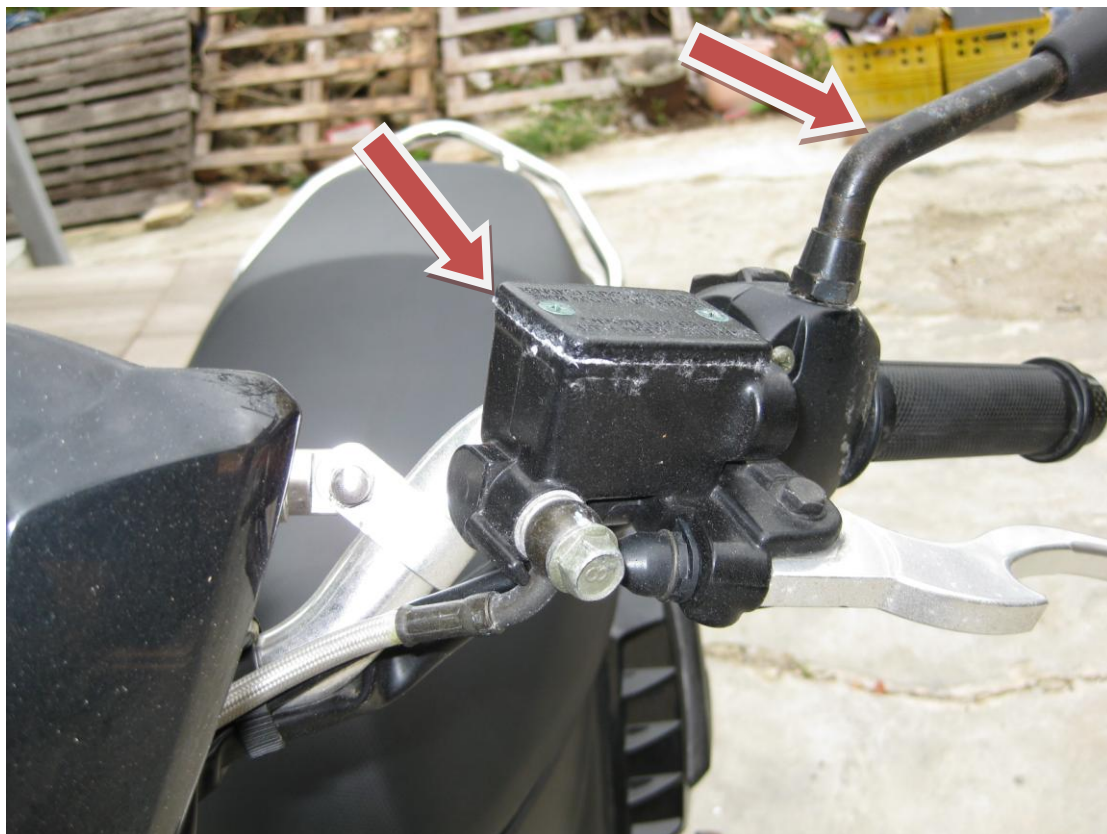
圖二、左邊煞車油杯出現白色銹蝕情形以及後照鏡支架生銹情形
