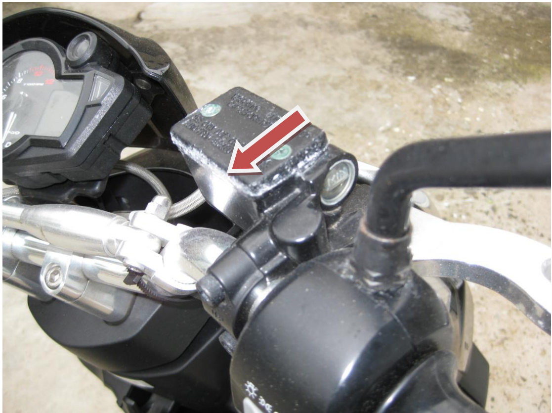
圖四、右邊煞車油杯出現白色銹蝕情形
