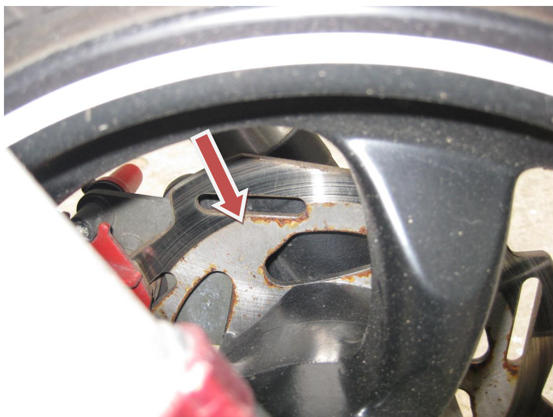
圖十二、碟煞盤生銹情形
