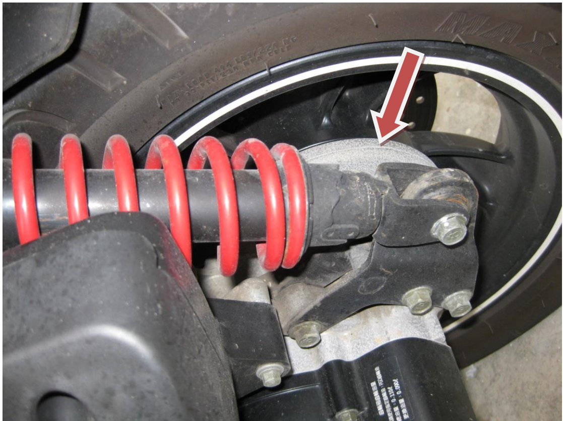
圖八、引擎 Case 鋁合金部份起白色氧化物，嚴重銹蝕（僅以清水洗車）
