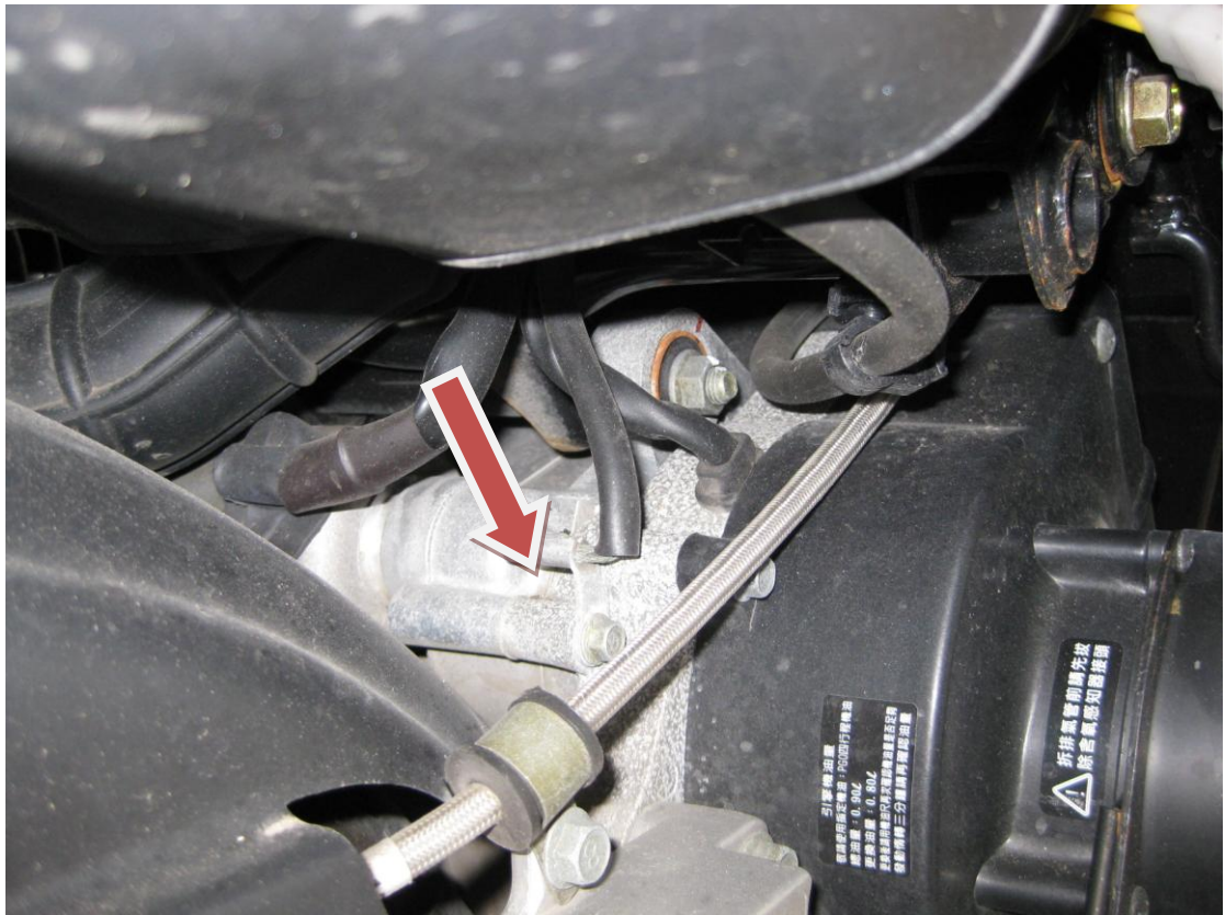
圖十、引擎 Case 鋁合金部份起白色氧化物，嚴重銹蝕（僅以清水洗車）
