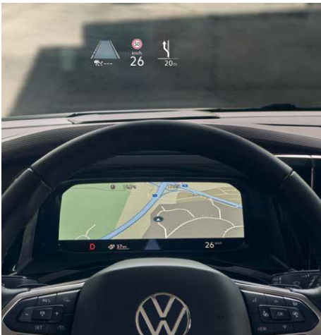
HUD抬頭顯示器 HUD抬頭顯示器將速度、導航和駕駛輔助系統投影在前方擋風玻璃上，讓駕駛專注駕駛的同時，可同時看到即時的行車資訊。(Style車款)
