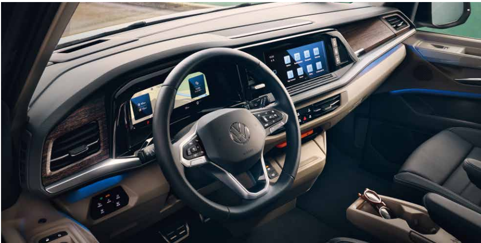
Active Info Display全邏輯數位化儀表板 大型互動式10.25吋全邏輯數位化儀表板，數位化顯示包括行車數據、音訊、通訊、駕駛輔助系統等設定，兼顧行車資訊辨識度及駕駛便利性。
