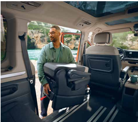
全新座椅滑軌系統/易拆卸設計 全新輕量化舒適座椅，易拆卸的設計搭載全新設計滑軌，拆裝時僅需對齊滑軌，輕鬆拆裝創造多變的車艙空間。
