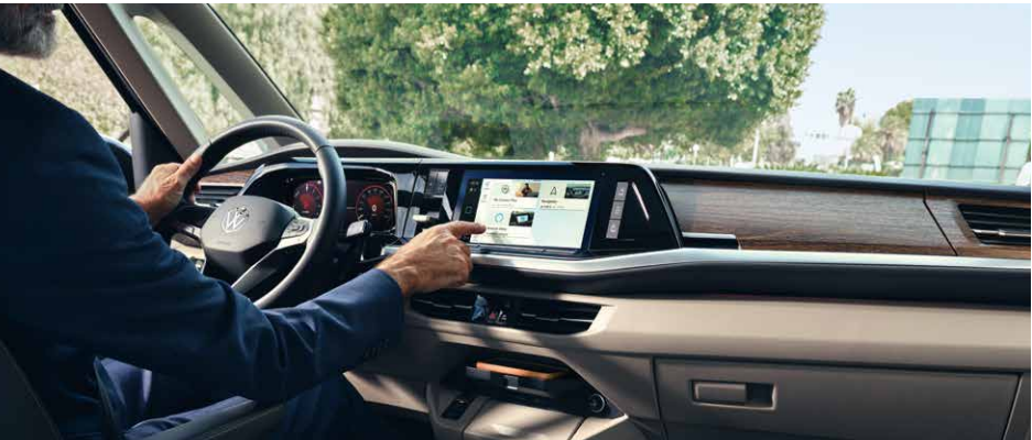
Discover Pro 10吋多媒體鏡面觸控螢幕音響主機 數位觸控化的操作介面更為人性科技化，輕鬆藉由觸控螢幕操作和設定主要功能，並依照喜好設定首頁的快捷按鍵；主機下方的Touch Slider數位觸控列，可控制空調、音量和導航地圖縮放等功能，讓您趟旅程都輕鬆簡單，毫不費力。
