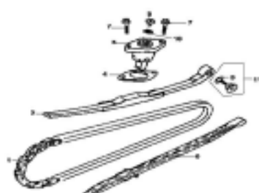
E-05 凸輪軸鏈條/張力器 CAM CHAIN/TENSIONER
