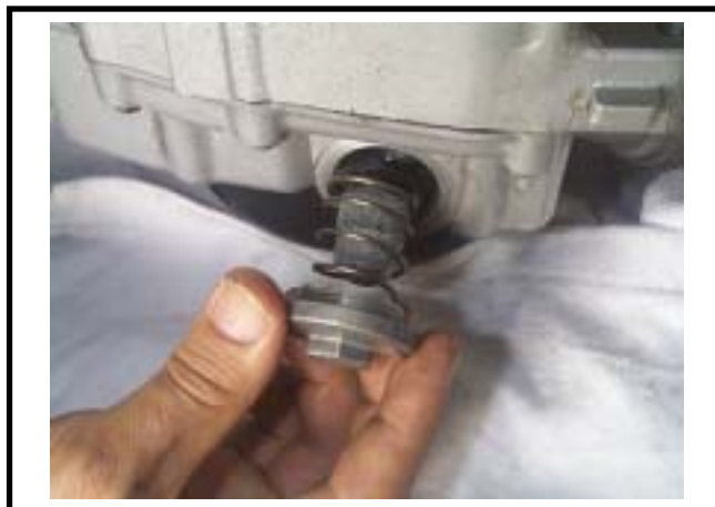
機油洩漏螺栓
