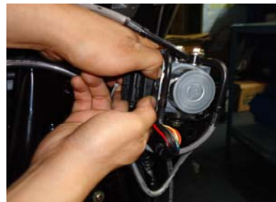
2. 用雙手拇指上下平均將排線壓入液壓調節器(排扣自然往上)
