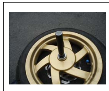
3. 使用軸承安裝工具安裝
