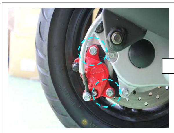
⊙ 拆下後煞車夾固定螺絲
