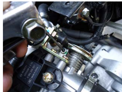
用六角板手調整 ISC 齒數，後鎖緊。
