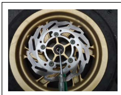
1. 使用液字起子將油封拆下
