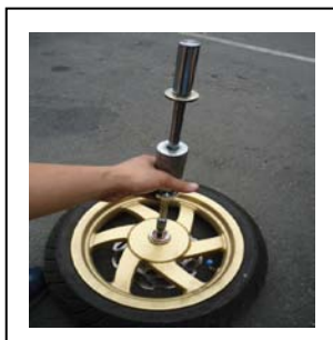
2. 使用軸承拆卸工具拆卸
