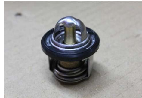
節溫器上防水橡膠不可變形或破損
