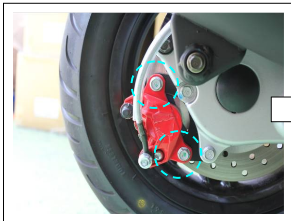
⊙拆下後煞車夾固定螺絲
