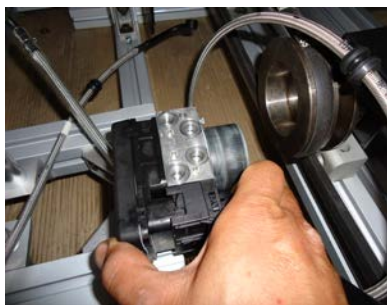
2. 將排線裝上液壓調節器 壓緊(排扣往上)
