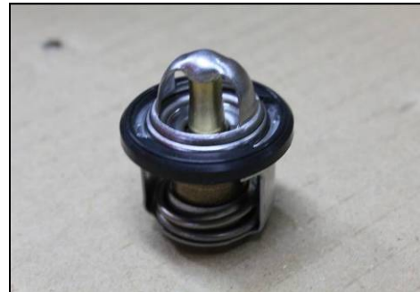
節溫器上防水橡膠不可變形或破損
