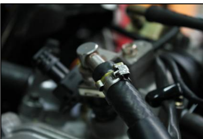
使用管夾拆卸工具，拆卸管夾。
