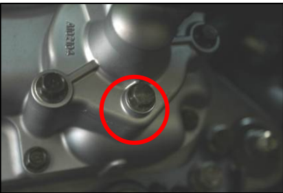
拆除卸水螺栓，卸除冷卻水。
