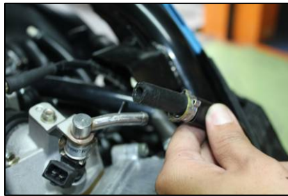
拔開高壓油管。 注意: 拆卸高壓油管前請先將管內油壓卸除
