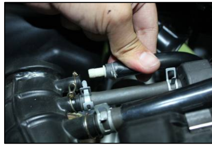
拆除引擎騎管及空濾上所有的真空軟管。
