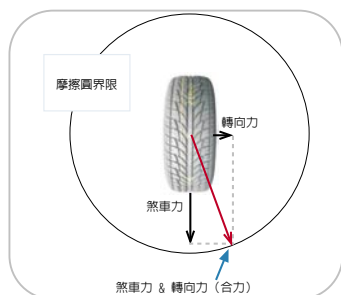
圖2C 隨著縱向力（煞車或驅動力）的增加時，橫向力（轉向力）會減少
